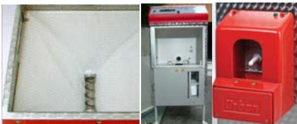
Pulverbeholderen rommer ca. 25 kg. Automaten har dobbel dør med blandekaret i eget avlukke.
